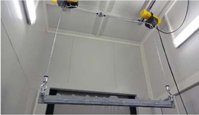
Ein Synchron-Kettenaufzugsystem ermöglicht das Anheben, Ausschachten und Spalten von Tierkörpern aller Art.
